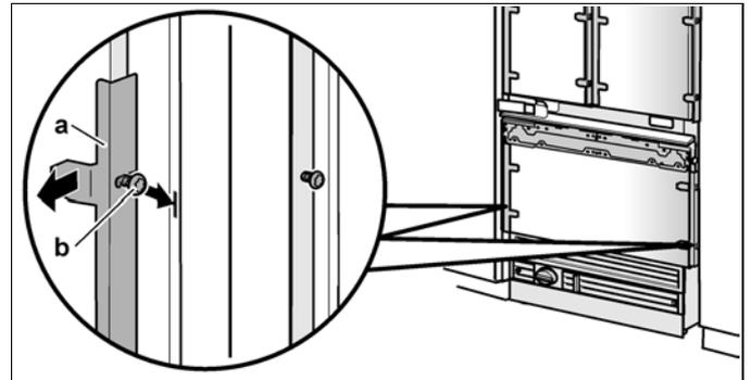
2. Inserire le squadre di fissaggio smontate (a) nelle guide di fissaggio (b) sulla porta del mobile.
