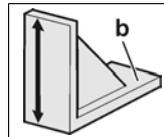
Per la corretta regolazione di questa altezza usare la dima di montaggio (b). Il bordo superiore della dima deve coincidere con il riferimento sull'apparecchio.
