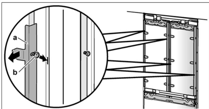
2. Inserire le squadre di fissaggio smontate (a) nelle guide di fissaggio (b) sulla porta del mobile.
