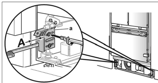
5. Fissare il rivestimento dello zoccolo.
