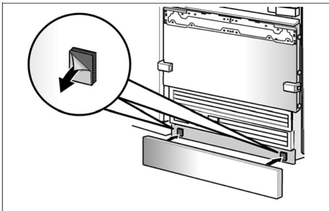
5. Lo zoccolo può essere avvitato da dietro al rivestimento dello zoccolo. Nel rivestimento dello zoccolo vi sono appositi fori.
