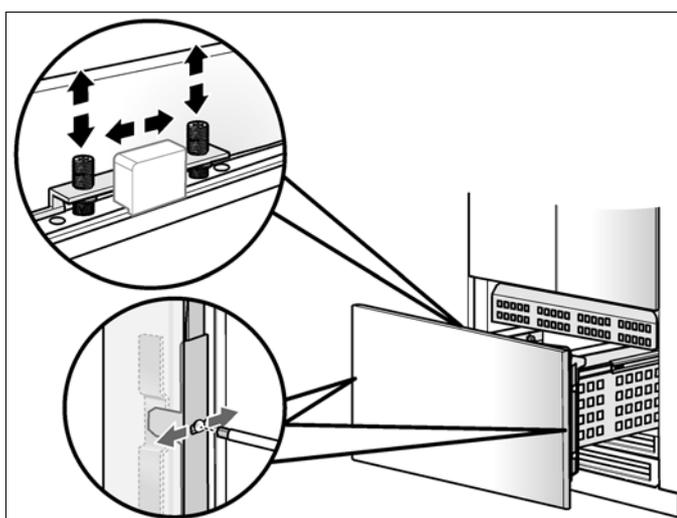
10. Avvitare e stringere i dadi sui perni filettati della guida di regolazione. Con ciò si blocca l'allineamento laterale della porta.
