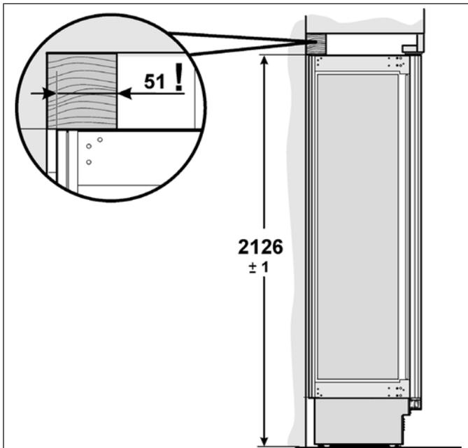
2. Tracciare l'altezza d'installazione (bordo inferiore dell'asse) sulla parete posteriore del vano.
