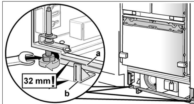
3. Eseguire l'allineamento verticale dell'apparecchio con i piedini sul lato posteriore. Usare la livella a bolla d'aria.
