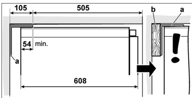
1. Stabilire i punti di fissaggio delle guide di sicurezza antiribaltamento.
