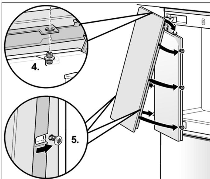
6. Allineare la porta del mobile con i perni filettati (cacciavite Torx). Controllare la misura della fessura su tutto il perimetro.
