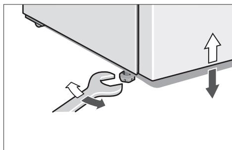
需要移动冰箱时，请先按逆时针方向调节塑料底脚，底脚离开地面后，再从冰箱的正面推动冰箱。
