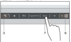
如果冷凍室內溫度高於電冰箱的警報溫度,冷凍室溫度會閃爍顯示,「alarm」字樣會亮起,同時警告訊號響起。
