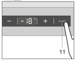
在速凍食品前應提前打開super極速冷凍功能幾個小時,讓冷凍室降至較低溫度,再放入食品。通常4-6小時便可以,若一次性冷凍大量食品,應提前打開super極速冷凍功能24小時。如速凍較少食品(大約2公斤),可不用打開速凍功能。
