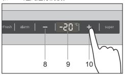
停止操作5秒鐘後,最後的溫度設定值被確認並貯存。
