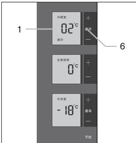
启动速冷模式后，冷藏室的制冷系统将在此温度设置下运行6小时左右，然后自动退出并恢复到原来的温度设定状态。
