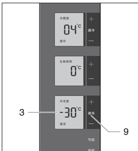
启动速冻模式后,冷冻室的制冷系统将在此温度设置下运行。
