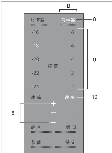
启动速冷模式后，冷藏室的制冷系统将在较低的温度设置下运行 6 小时左右，然后自动退出并恢复到原来的温度设定状态。
