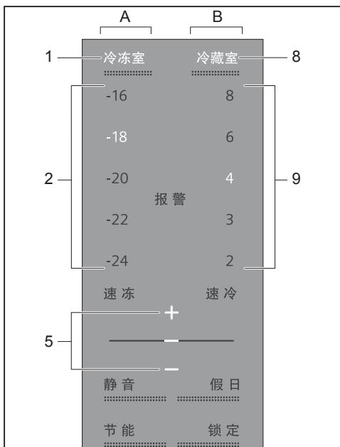
停止操作5秒钟后，最后的温度设定值被确认并储存。
