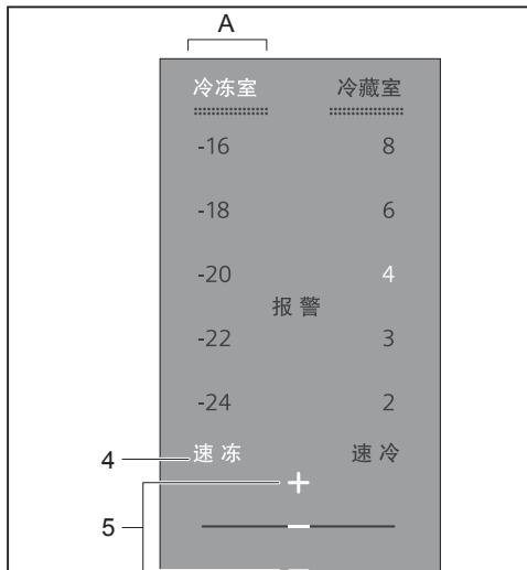
启动速冻模式后，冷冻室的制冷系统将较低的温度设置下运行。
