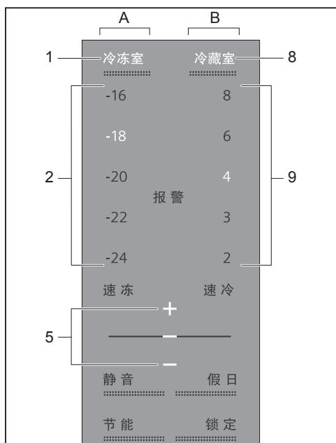
停止操作5秒钟后，最后的温度设定值被确认并储存。
