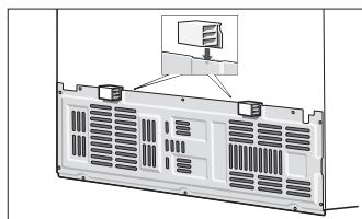
**!** 不要覆盖或堵塞冰箱背部的压缩机挡板上的通风格栅。避免靠近热源或阳光直接照射。
