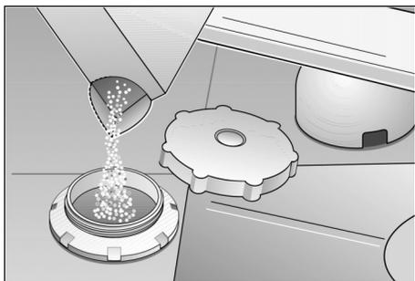
El piloto de aviso de la reposición de la sal **[4]** en el cuadro de mandos se ilumina y se apaga sólo al cabo de cierto tiempo, una vez que la concentración de sal en el agua de la instalación de descalcificación ha alcanzado una concentración suficiente.
