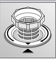
enroscar el filtro cilíndrico. ¡PRESTAR ATENCIÓN A LA POSICIÓN DE LA MARCA!
