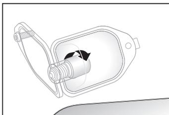
3. Dévissez l'ampoule dans le sens de la flèche.
