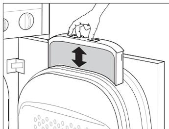
Au cours du séchage, des fibres se libèrent et se déposent sur le filtre sous forme de peluches.
