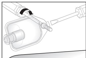
2. Dévissez la vis du cache de l'ampoule dans le sens de la flèche. Rabattez le cache de 90°. Si le cache est collé, glissez un outil plat (tournevis) dans la fente d'ouverture pour le dégager avec précaution.
